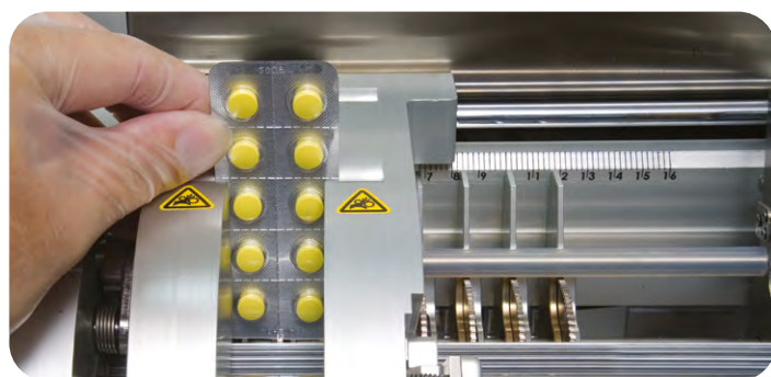
LA DB500 PEUT DÉBLISTER JUSQU'À 280 GÉLULES OU COMPRIMÉS PAR MINUTE.
